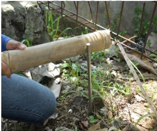
Menanam elektroda (spasi 5meter)
