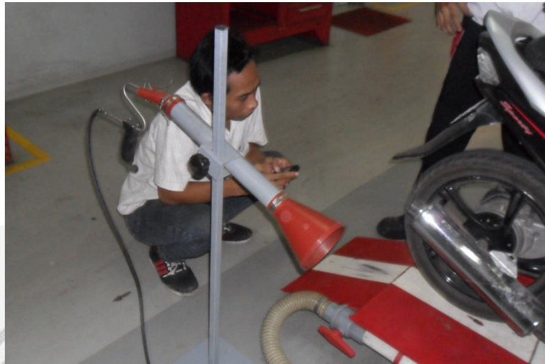
Corong penghubung dari gas analyzer ke knalpot
