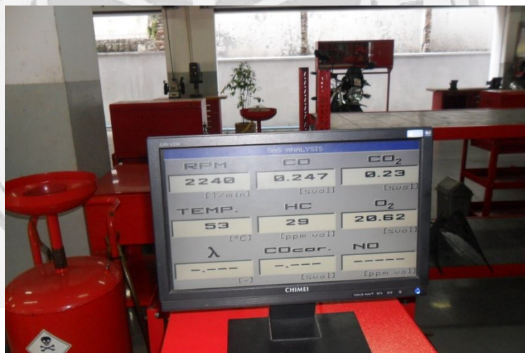
Monitor untuk melihat Rpm,kadar CO 2 ,O 2 ,HC,O 2
