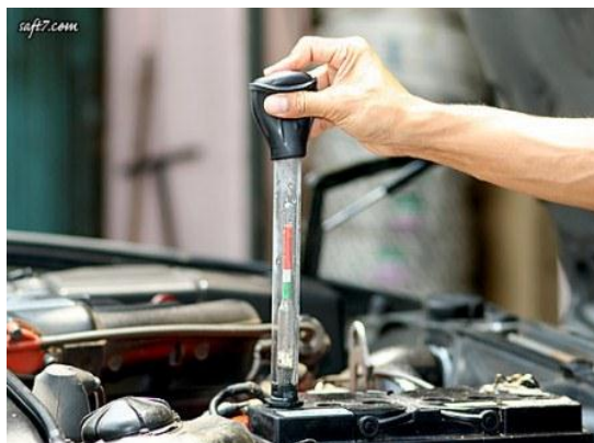
Gambar 2.6. Pengukuran Berat Jenis Baterai
