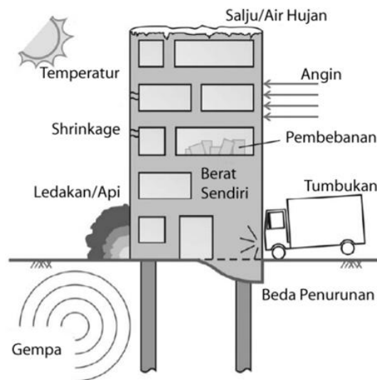
Gambar 2.9 Pembebanan pada Bangunan Gedung
