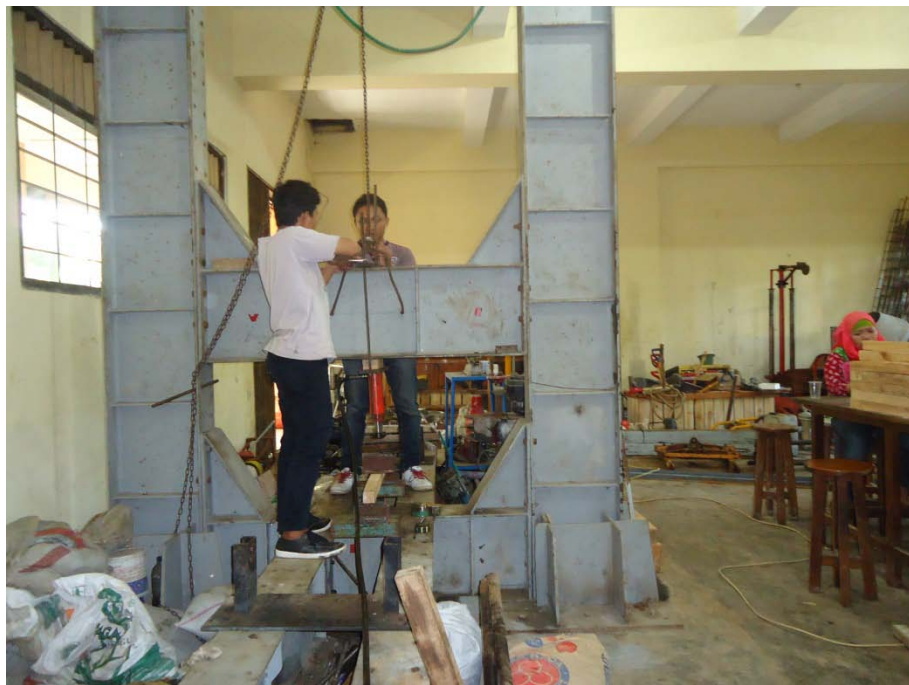
Mesin Uji Lentur ( Loading Frame )
