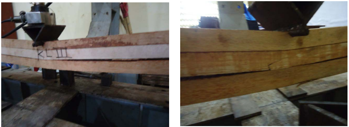
Gambar 4.3. Benda Uji Keteguhan Lentur Balok Laminasi
