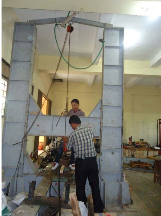
Mesin Uji Lentur ( Loading Frame )
