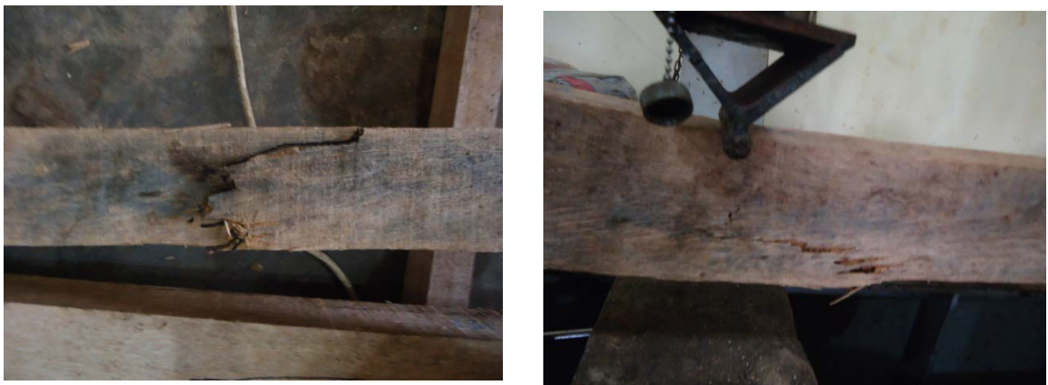
Gambar 4.2. Benda Uji Keteguhan Lentur kayu Kelapa
