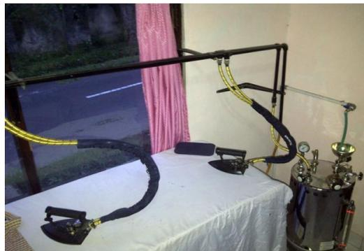
Gambar 2.1 Setrika uap tenaga gas atau setrika uap boiler (Maftukhah, 2013).
