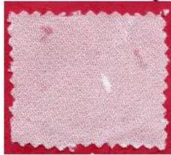
Gambar 2.7 Lapisan dalam *knit fusible interfaing* (Maftukhah, 2013).
