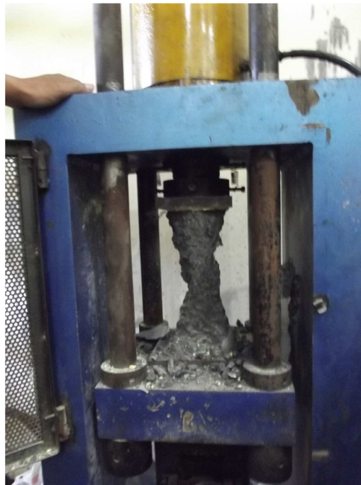
Gambar 6. Pengujian kuat tekan beton silinder
