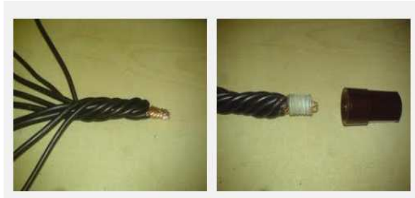
Gambar 2.3. Sambungan kabel yang benar
