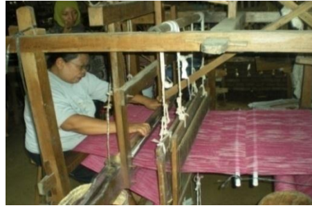
Gambar 2.14 Proses Penenunan (Sumber : Data Observasi Lurik Kembangan, Yogyakarta)
