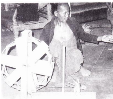
Gambar 2.10 Proses Mengantih (Sumber : Nian S. Djoemena 2000 : 18)
