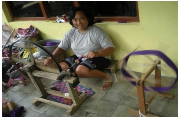
Gambar 2.11 Proses Penataan Benang (Sumber: Data Observasi Lurik Kembangan, Yogyakarta)
