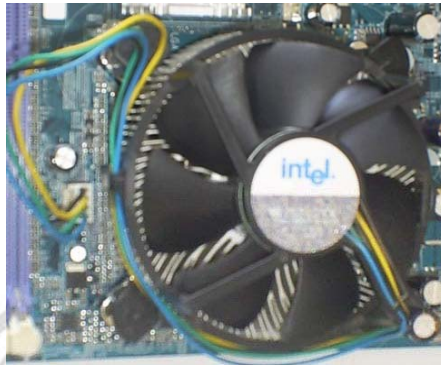
Gambar 2.17. Hasil pemasangan kipas pendingin prosesor
