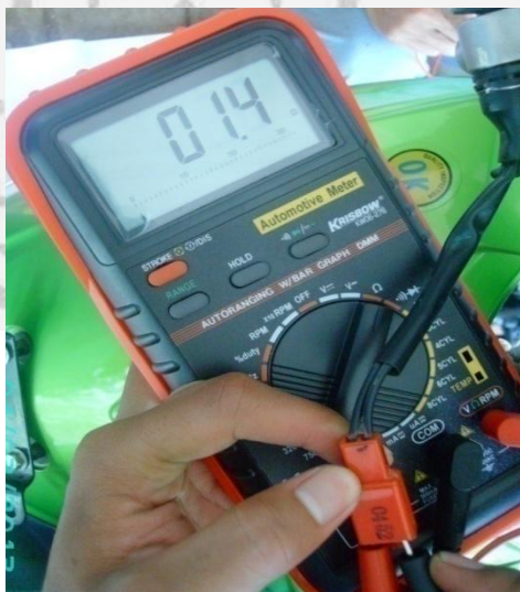
Gambar 3.31 Pemeriksaan tahanan pada saklar rem
