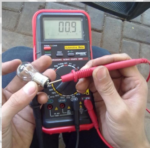
Gambar 3.34 Pemeriksaan tahanan pada bohlam lampu rem
