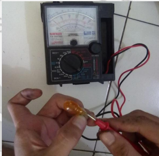
Gambar 3.35 Pemeriksaan tahanan bohlam signal tanda belok
