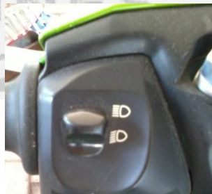
Gambar 3.3 Bentuk saklar lampu kepala ( dimmer switch ) pada Yamaha Mio-J
