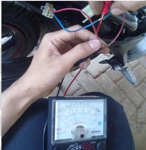
Gambar 3.29 Pengukuran tegangan coupler lampu belakang
