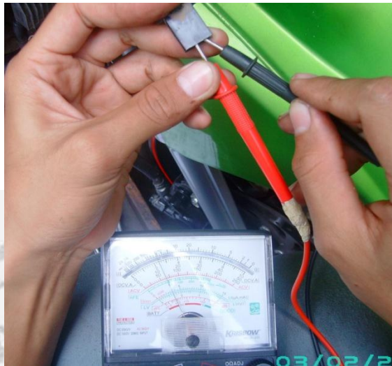
Gambar 3.38 Pengukuran tegangan coupler signal belok
