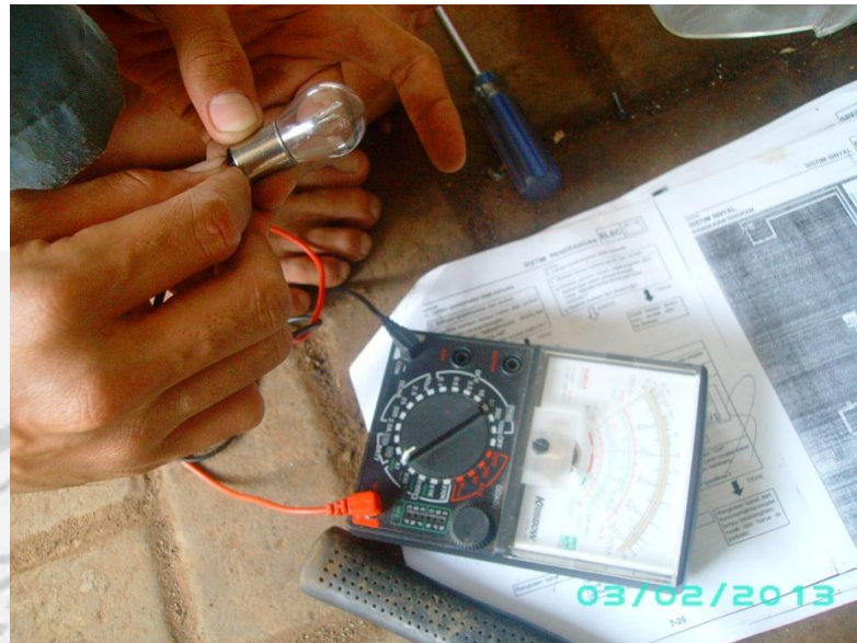
Pengecekan bohlam lampu pada Yamaha mio-j
