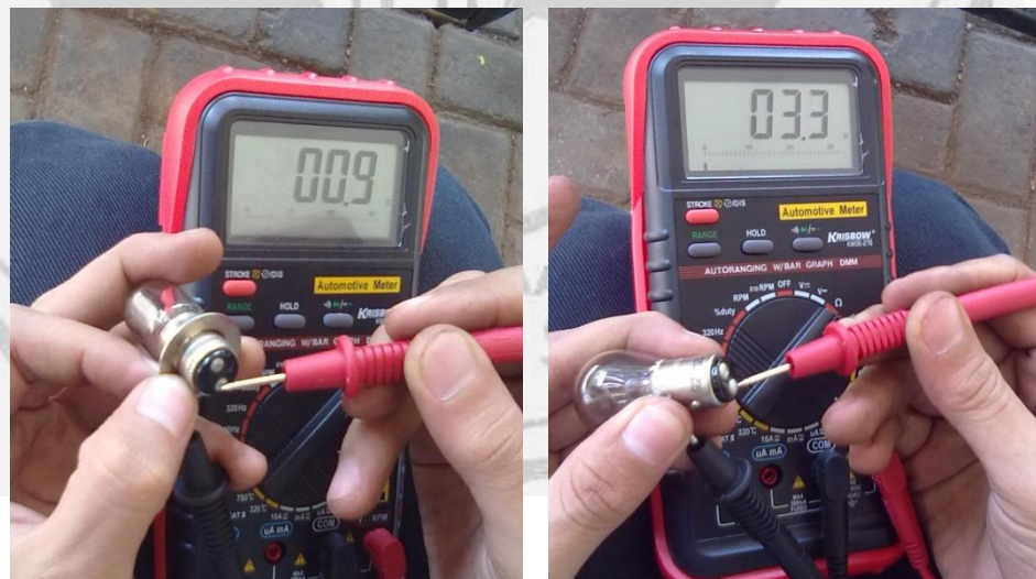
Gambar 3.26 Pengukuran tahanan bohlam lampu depan dan belakang
