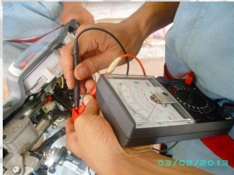
Pengetesan saklar-saklar pada sepeda motor Yamaha mio j
