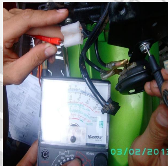
Gambar 3.37 Pengukuran tegangan signal relay
