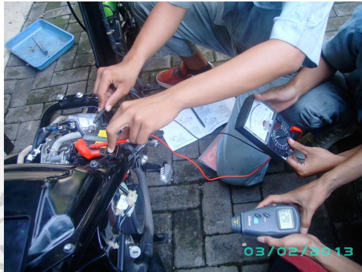
Pengecekan tegangan pengisian baterai pada Yamaha Mio-J
