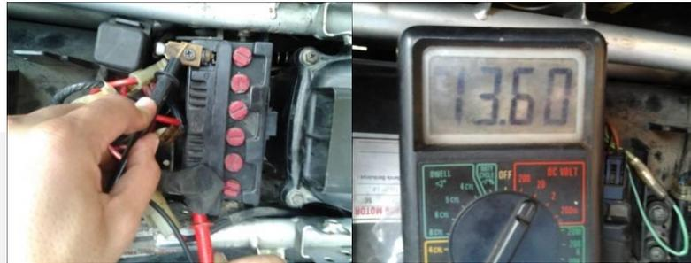
Gambar 3.33 Proses pengukuran tegangan output dari baterai
