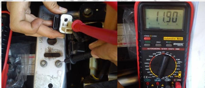
Gambar 3.37 Pengukuran voltase masuk pada flasher
