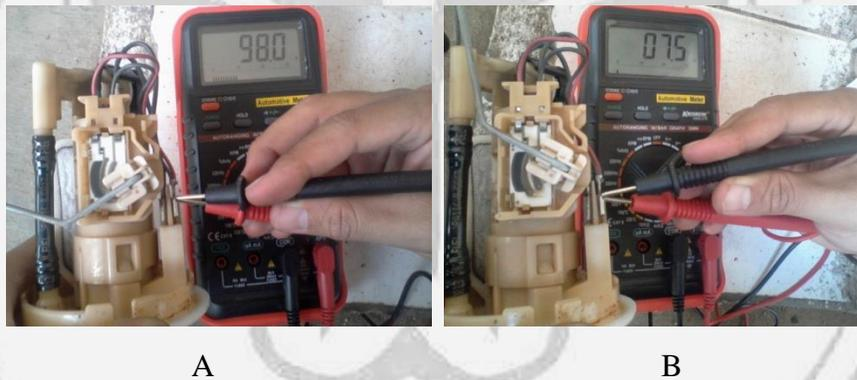
Gambar 3.37 Proses mengukur tahanan *fuel sender unit* ketika *empty* dan *full*
