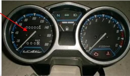
Gambar 3.30 Panel indikator kecepatan pada Yamaha Vixion
