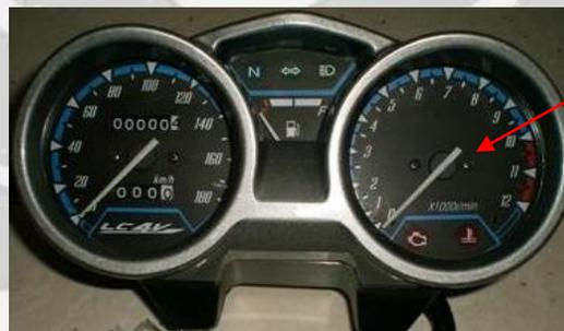
Gambar 3.32 Panel indikator Rpm pada Yamaha Vixion
