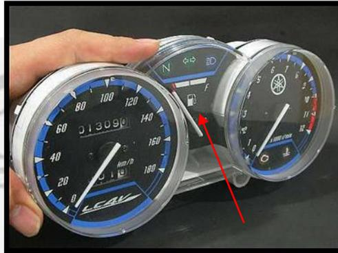
Gambar 3.27 Panel indikator bahan bakar pada Yamaha Vixion
