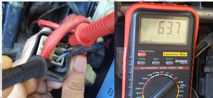
Gambar 3.36 Pengukuran tahanan relay
