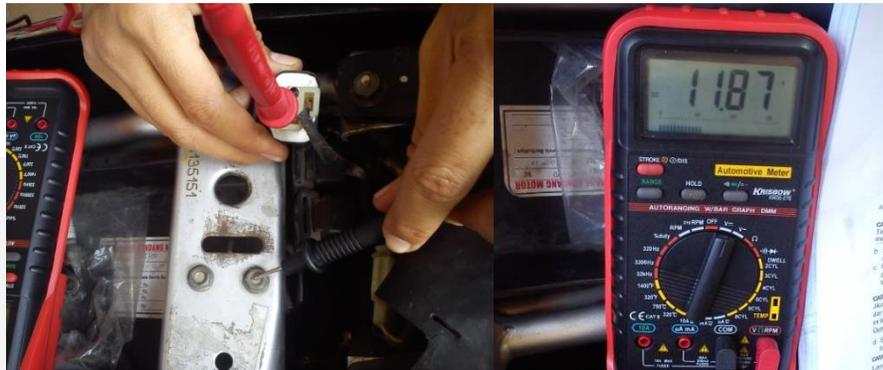
Gambar 3.38 Pengukuran voltase keluar pada flasher
