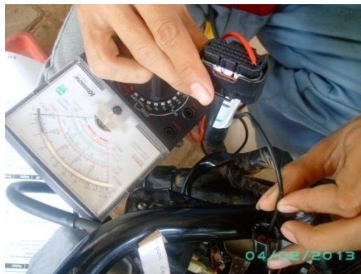
Gambar 3.26 Memeriksa hubungan kabel abu-abu/merah antara connector O 2 sensor dan connector ECU
