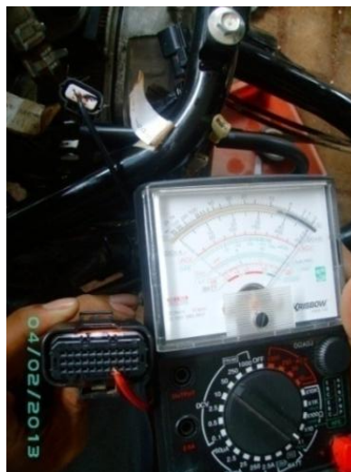
Gambar 3.11 Memeriksa hubungan kabel biru muda antara connector idle speed control dan connector ECU
