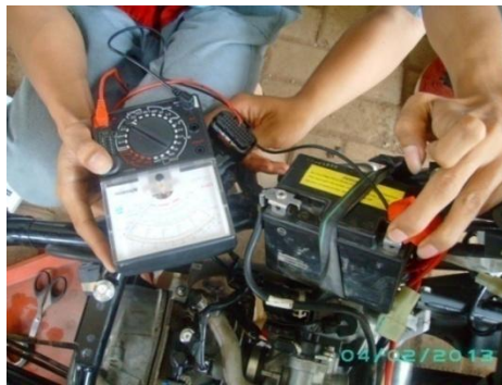
Gambar 3.7 Memeriksa hubungan kabel merah antara battery dan connector ECU
