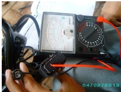
Gambar 3.27 Periksa hubungan kabel hitam/biru antara connector engine temperature sensor dan connector ECU
