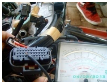
Gambar 3.18 Memeriksa hubungan kabel biru antara connector intake air pressure sensor dan connector ECU
