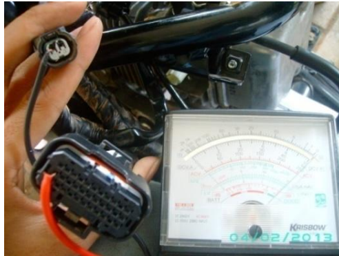
Gambar 3.28 Memeriksa hubungan kabel hijau/merah antara connector engine temperature sensor dan connector ECU
