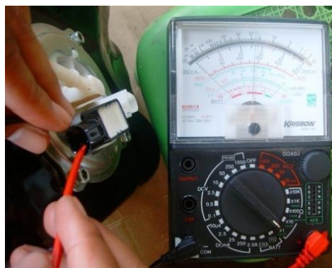
Gambar 3.5 Pengukuran Tahanan Pompa Bahan Bakar
