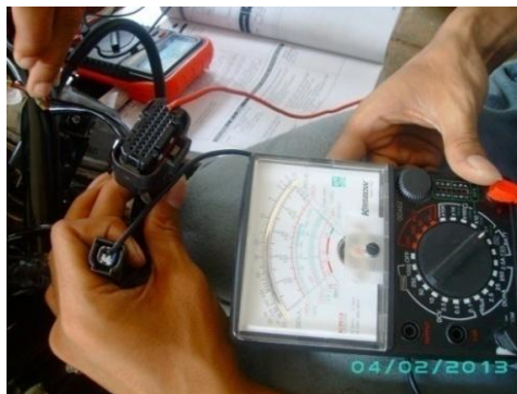
Gambar 3.6 Memeriksa hubungan kabel orange/hitam antara connector fuel injector dan connector ECU
