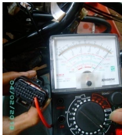
Gambar 3.9 Memeriksa hubungan kabel hijau/kuning antara connector idle speed control dan connector ECU
