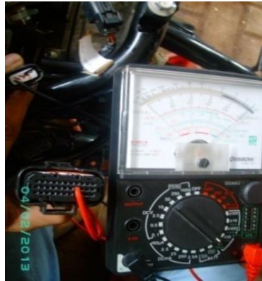
Gambar 3.10 Memeriksa hubungan kabel abu-abu antara connector idle speed control dan connector ECU
