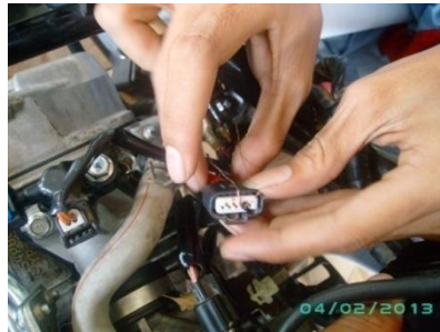
Gambar 3.22 Langkah pemasangan serabut tembaga.
