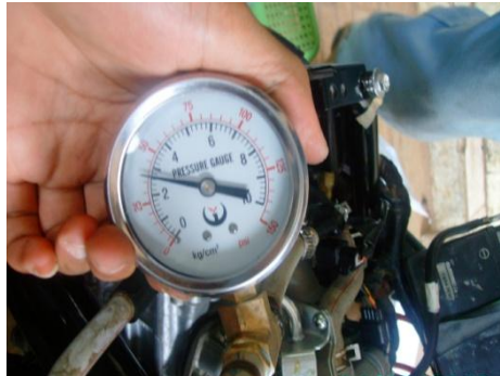
Gambar 3.4 Pengukuran Tekanan Bahan Bakar
