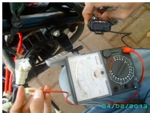
Gambar 3.25 Memeriksa hubungan kabel hitam/biru antara connector crankshaft position sensor dan connector ECU
