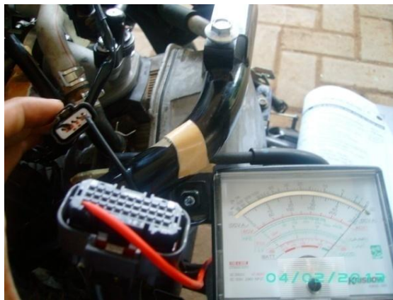
Gambar 3.14 Memeriksa hubungan kabel coklat/putih antara connector intake air temperature sensor dan connector ECU
