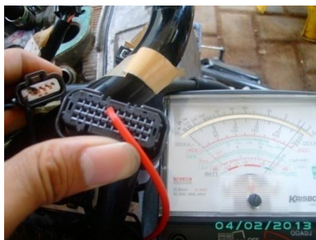
Gambar 3.20 Memeriksa hubungan kabel kuning antara connector throttle position sensor dan connector ECU
