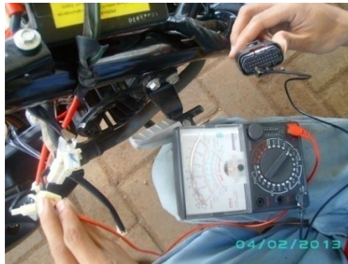
Gambar 3.24 Memeriksa hubungan kabel putih/merah antara connector crankshaft position sensor dan connector ECU
