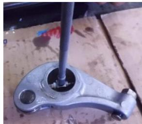
Gambar 60. Mengukur diameter dalam *rocker arm*.
