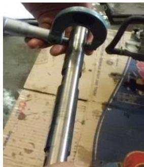
Gambar 61. Mengukur diameter luar *shaft*.
