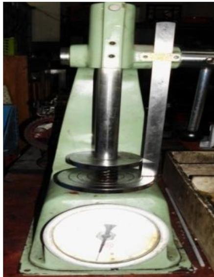
Gambar 66. Mengukur tekanan pegas katup.
