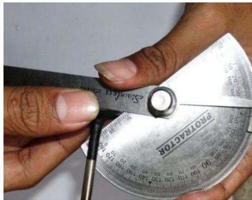
Gambar 64. Mengukur kemiringan dudukan katup.
