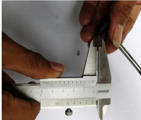
Gambar 63. Mengukur lebar dudukan katup.
