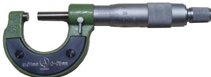
Gambar 37. Mikrometer.
