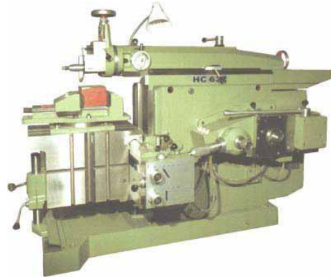
Gambar 5. Mesin skrap. Widarto (2008: 235)
