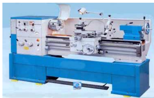
Gambar 1. Mesin bubut konvensional. Sumbodo, dkk (2008:230)
