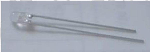
Gambar 2.8 Anoda dan katoda pada LED
