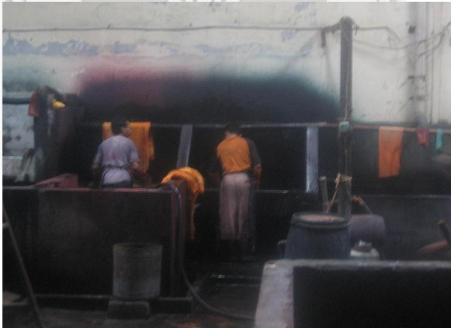
Gambar 8. Proses pencelupan
