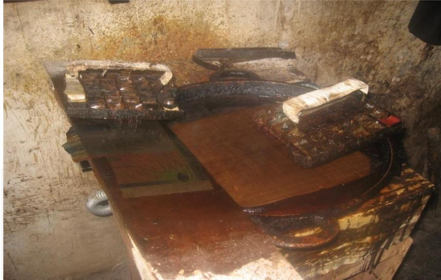
Gambar 5. Alat yang digunakan untuk batik cap
