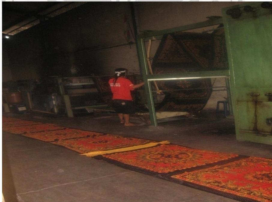
Gambar 14. Proses pencelupan, penghilang malam dan pengeringan batik printing
