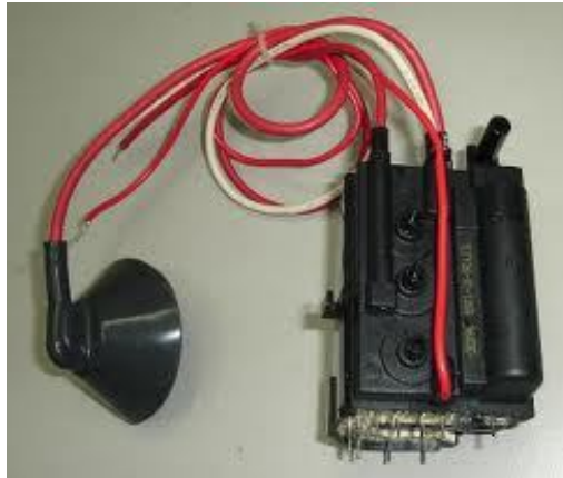
Gambar 2.8 Trafo Fly Back
