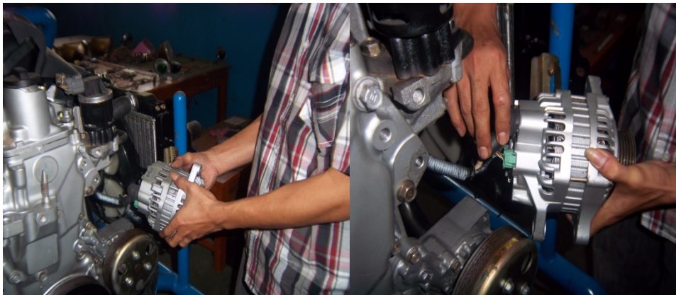
Gambar pelepasan alternator dari engine stand
