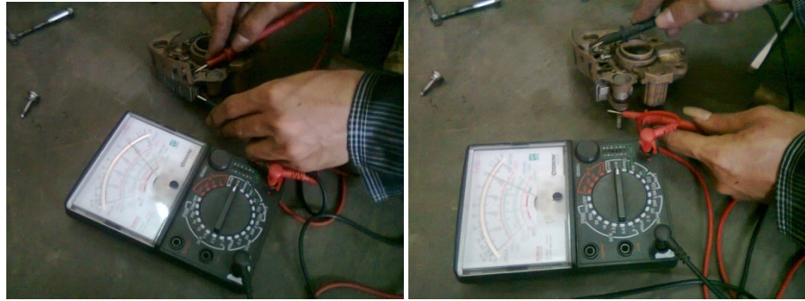
Gambar pemeriksaan komponen alternator
