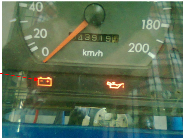
Gambar 3.14 Saat kunci kontak pada posisi ON
