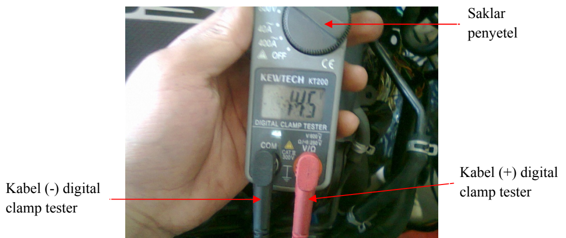
Gambar 3.21 Mengukur tegangan output alternator
