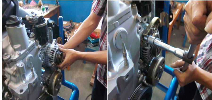
Gambar pemasangan alternator ke engine stand
