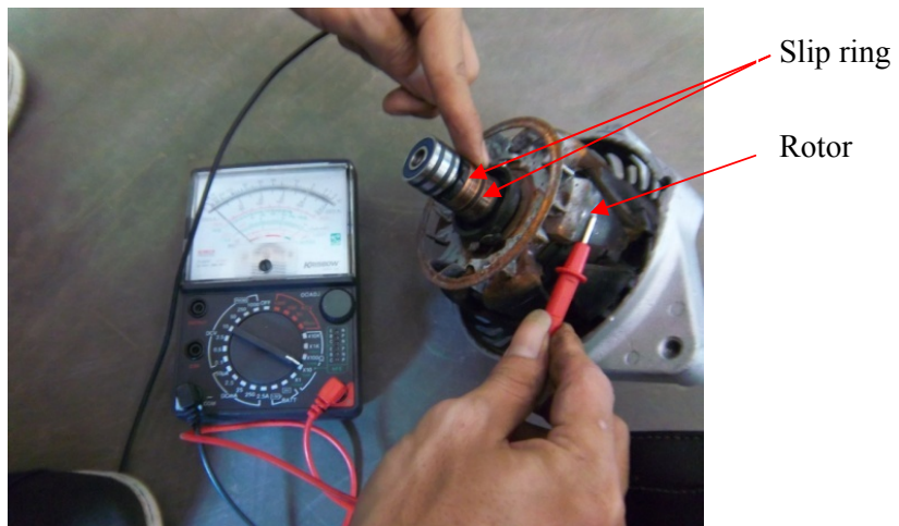
Gambar 3.8 Pemeriksaan rotor dengan massa
