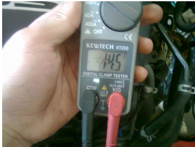
Gambar hasil pengujian tegangan output alternator
