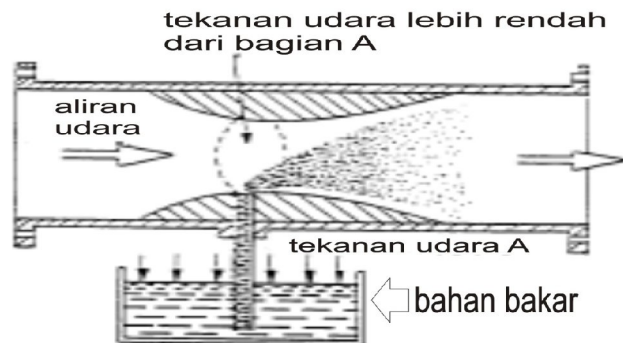
Gambar 3.2. Cara Kerja Venturi (Sumber : Sujarwo, 2006)
