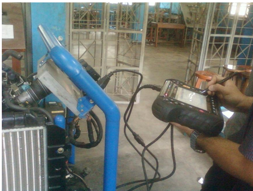
Gambar 53. Pemeriksaan ECT dengan Scan Tool
