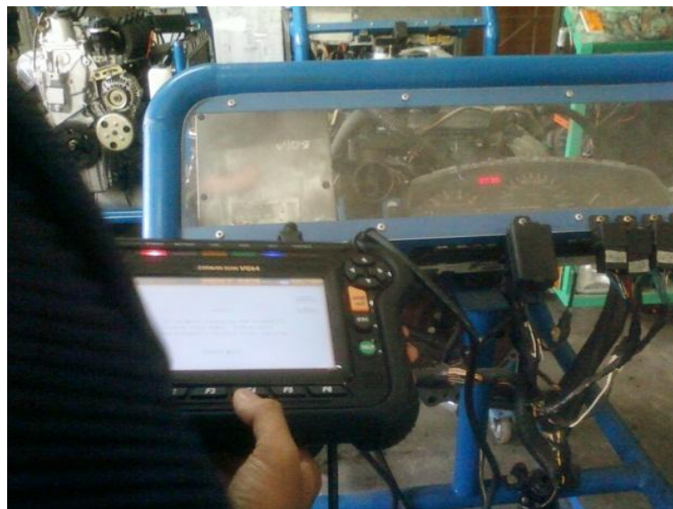
Gambar 29. Pemeriksaan Throttle body dengan scan tool
