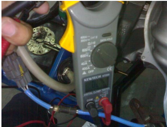
Gambar 54. Pemeriksaan Socket ECT sensor
