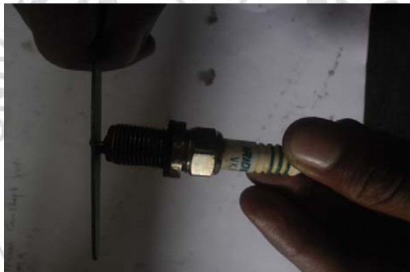
Gambar 3.5. Pemeriksaan Kerenggangan Celah Busi
