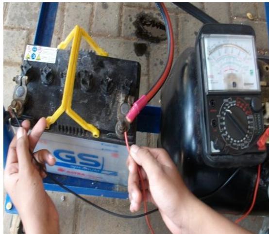
Gambar 3.15. Hasil pengukuran tegangan Baterai
