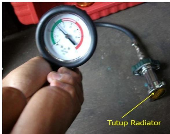
Gambar 3.11. Pemeriksaan kebocoran Rutup Radiator
