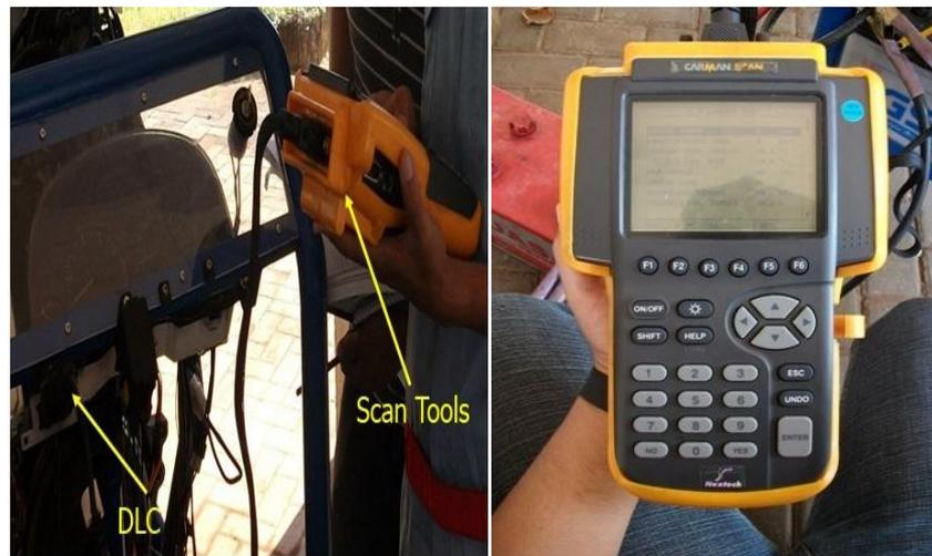
Gambar 3.25 DLC dan Scan tool yang dihubungkan
