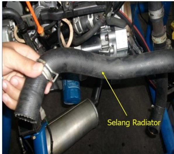
Gambar 3.9. Pengecekan Slang Radiator
