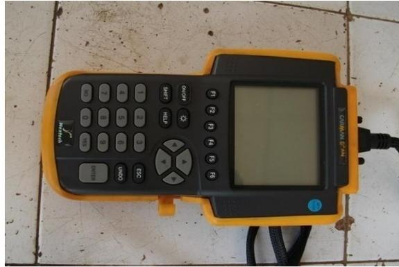
Gambar 2.12. *Scan tool* atau *scan*
