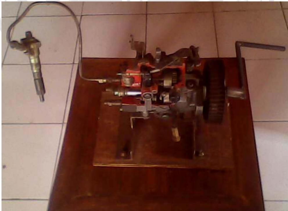
Gambar 4.2. Alat Peraga Sistem Pompa Injeksi Distributor
