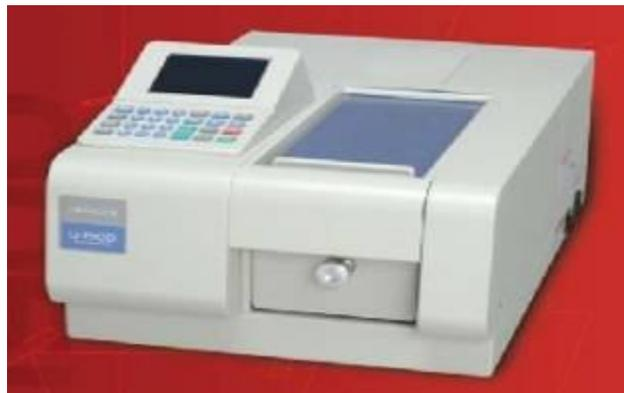
Gambar 6. Spektrofotometer HACH DR/2000
