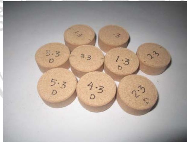
Gambar 4.8. Pembriketan dengan temperatur cetakan 140°C.
