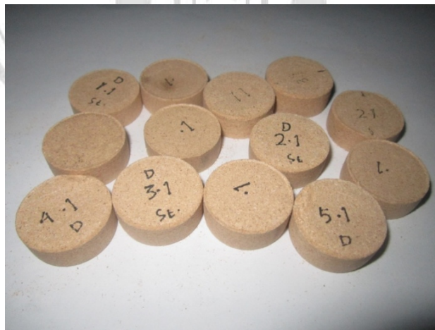
Gambar 4.6. Pembriketan dengan temperatur cetakan 100^{\circ}\text{C} .
