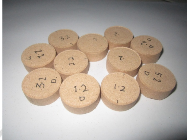
Gambar 4.7. Pembriketan dengan temperatur cetakan 120°C.
