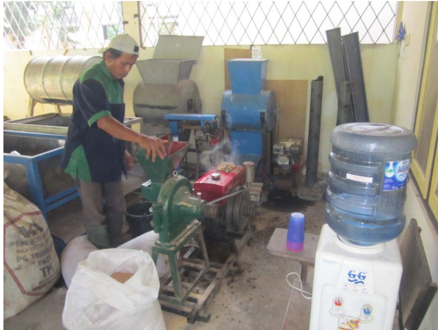
Gambar 3 . Penggilingan Serbuk Kayu Sengon Sebagai Bahan Baku
