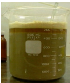
Gambar 4.1. Warna Zeolit pada Perendaman HCl 6N.
