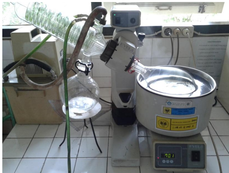
b. Proses evaporasi dengan rotary vacuum evaporator
