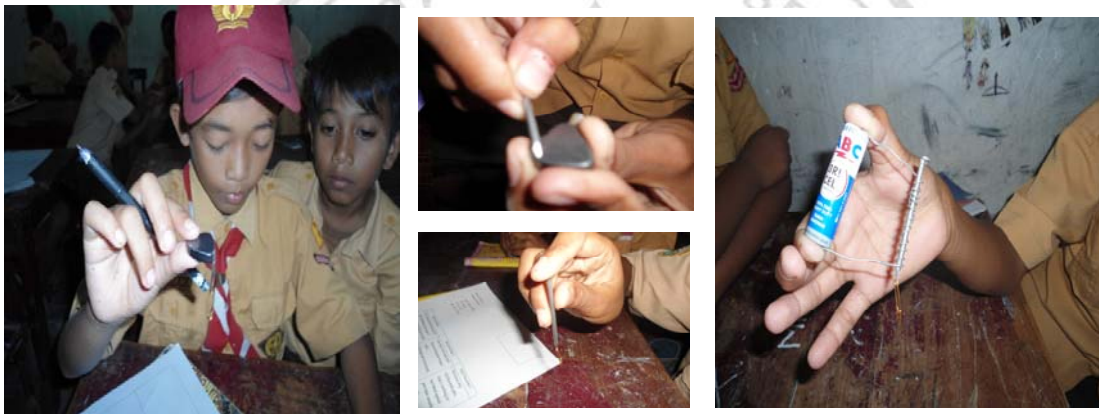
Siswa Mempraktikan Membuat Magnet dengan Cara Induksi, Menggosok, dan Mengalirkan Arus Listrik
