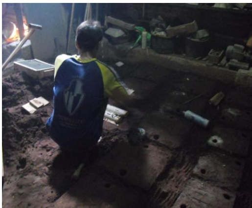
Proses pembuatan cetakan di pasir
