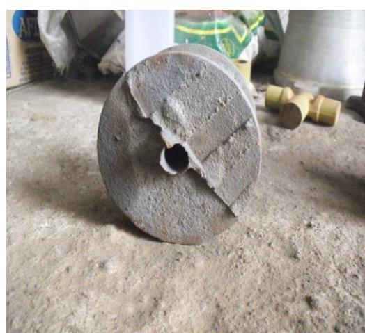
Logam yang telah dicetak dan belum dihaluskan
