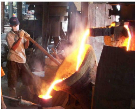
Proses peleburan besi dengan dapur kupola
