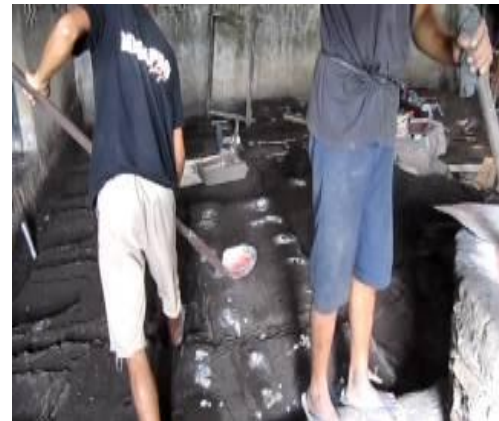
Proses penuangan besi cair ke dalam cetakan pasir
