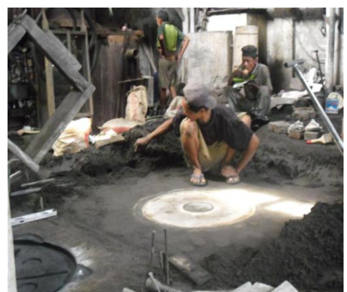
Proses pembuatan cetakan di pasir
