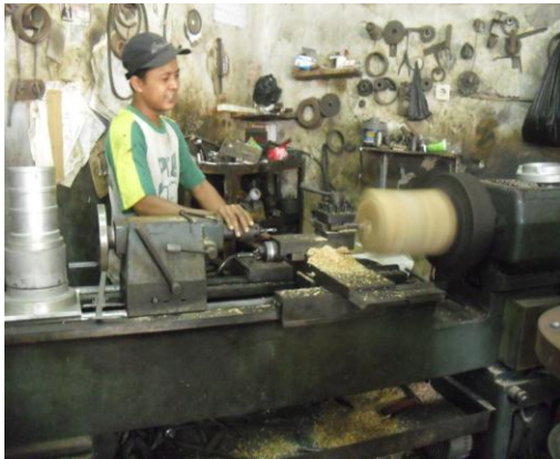
Proses pembuatan "model" dari kayu
