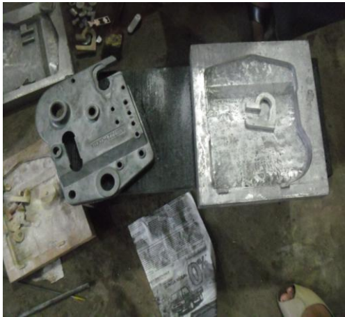
Proses penghalusan cetakan logam yang siap untuk di bubut.
