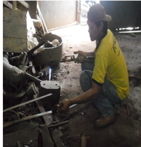
Proses mengelas (menyambung logam)
