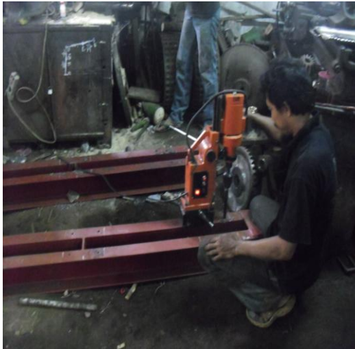
Proses mengebor untuk pintu air
