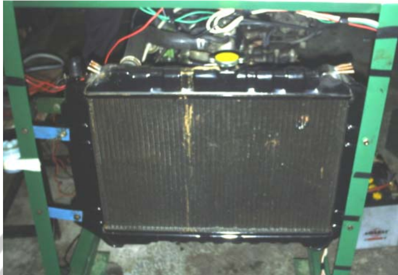
Gambar 01. Saluran pemanasan pada upper tank radiator
