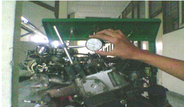
Gambar 20. Penyetelan Dial Indikator
