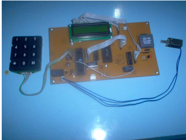
Rangkaian kunci pintu dengan RFID tampak atas
