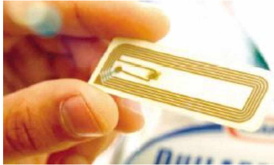
Gambar 2.1. RFID tag dengan silicon chip dan antena eksternal
