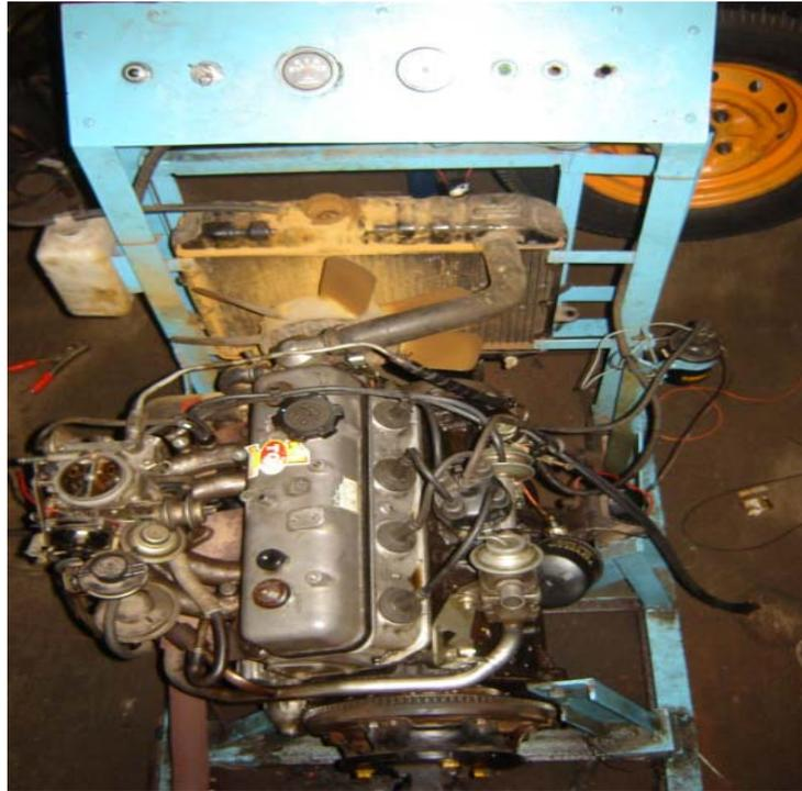
Gambar 31. Motor Toyota 4 langkah 4 silinder 1500 cc.
