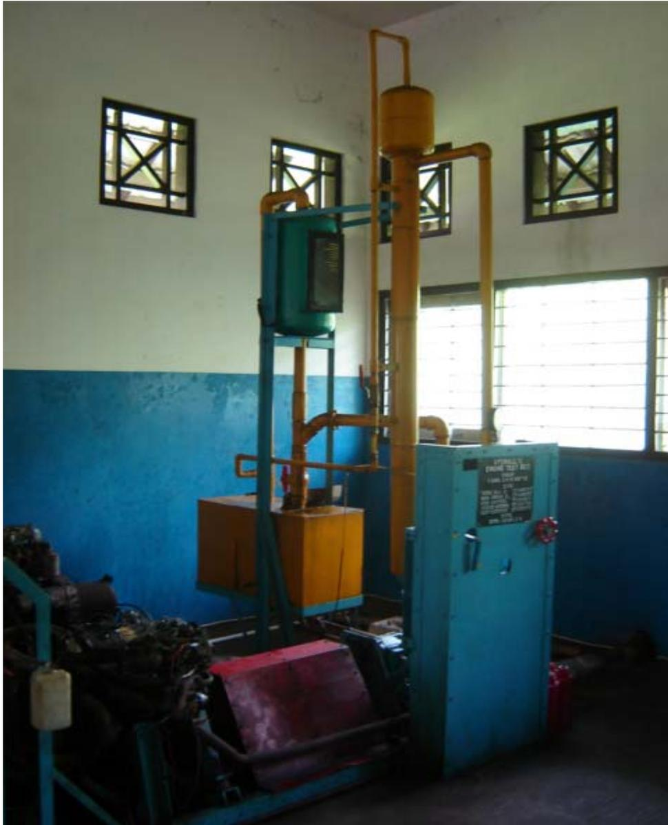
Gambar 23. Motor 4 langkah 4 silinder 1500 cc yang terpasang pada *Hydraulic Engine Test Bed*.
