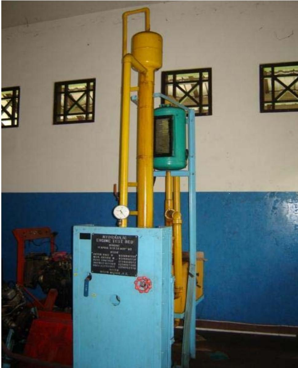
Gambar 24. *Hydraulic Engine Test Bed* yang dilengkapi panel-panel pengukur.
