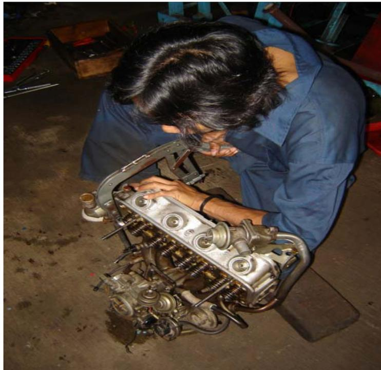
Gambar 34. Membuka katup dari kepala silinder.
