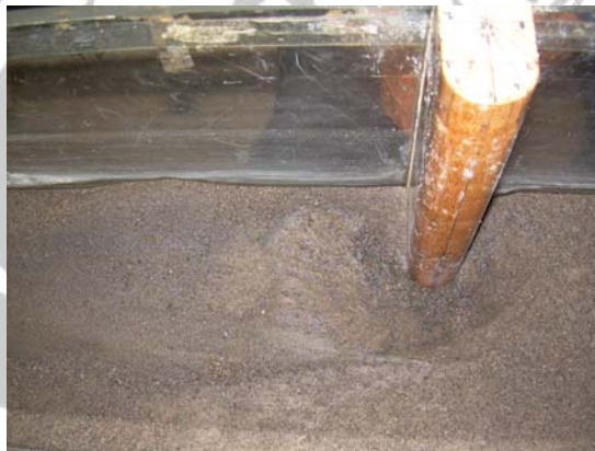
Hasil Gerusan pada Abutmen dengan Kedalaman Aliran 90 mm
