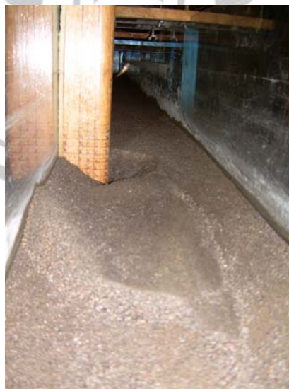
Hasil Gerusan pada Abutmen dengan Kedalaman Aliran 100 mm
