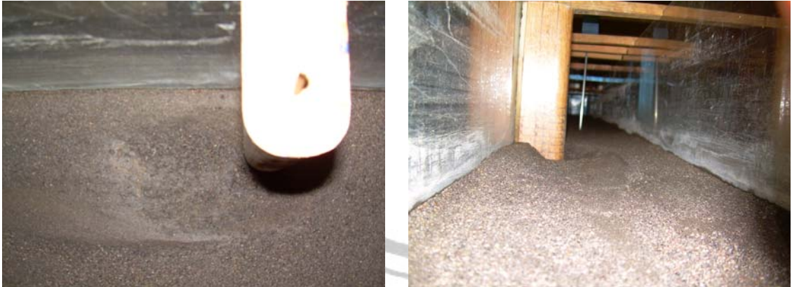
Hasil Gerusan pada Abutmen dengan Kedalaman Aliran 110 mm
