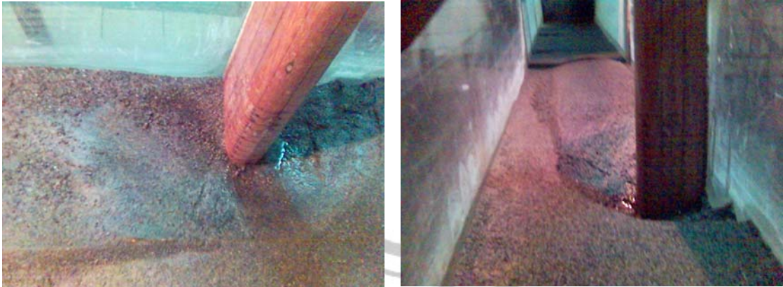
Hasil Gerusan pada Abutmen dengan Kedalaman Aliran 90 mm
