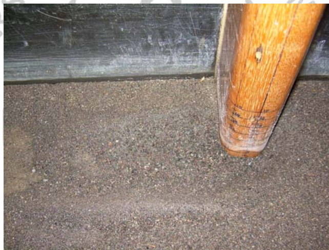
Hasil Gerusan pada Abutmen dengan Kedalaman Aliran 120 mm
