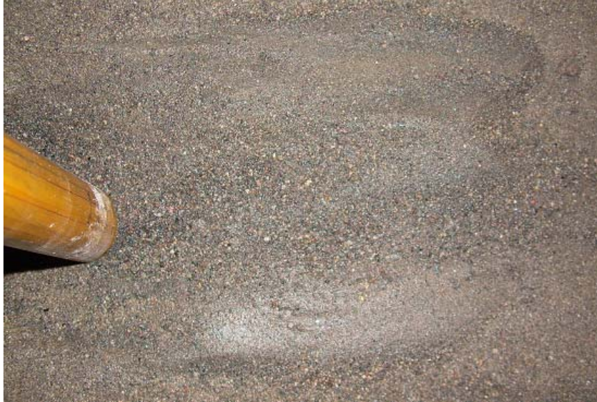
Hasil Gerusan Pilar lenticular sudut 10^0 pada bagian belakang pilar
