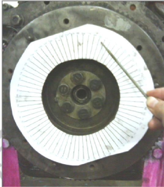
Gambar 28. Pencarian sudut pembukaan dan penutupan katup
