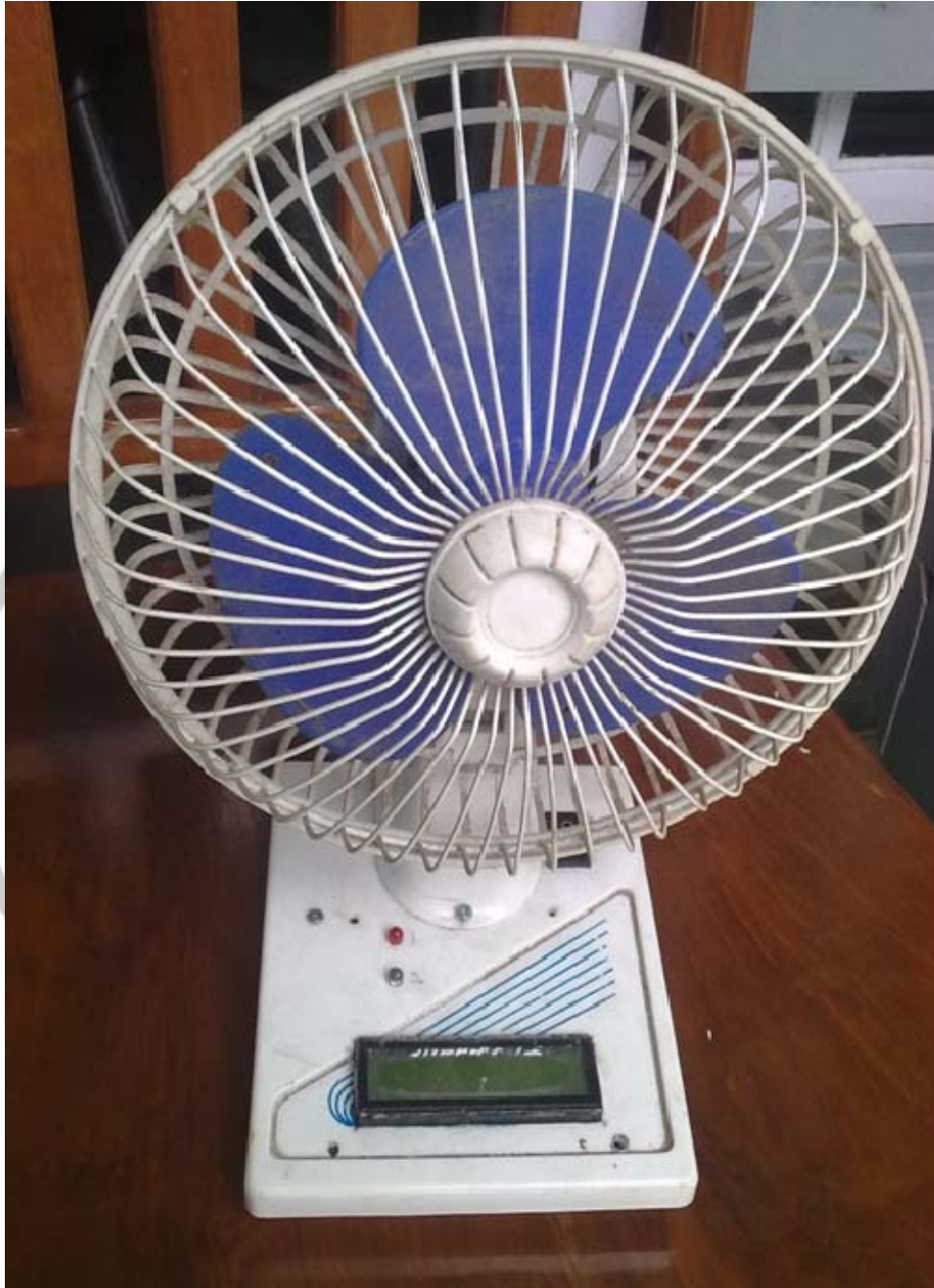
Alat Pengaturan Kipas Berbasis Mikrokontroler Dengan Menggunakan Sensor Suhu.
