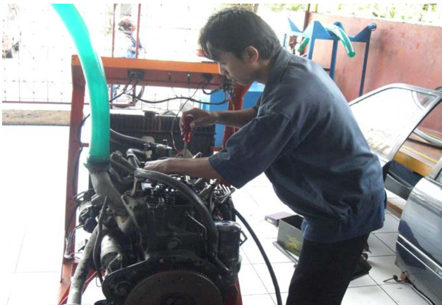
Gambar 4. Penyetelan celah katup buang
