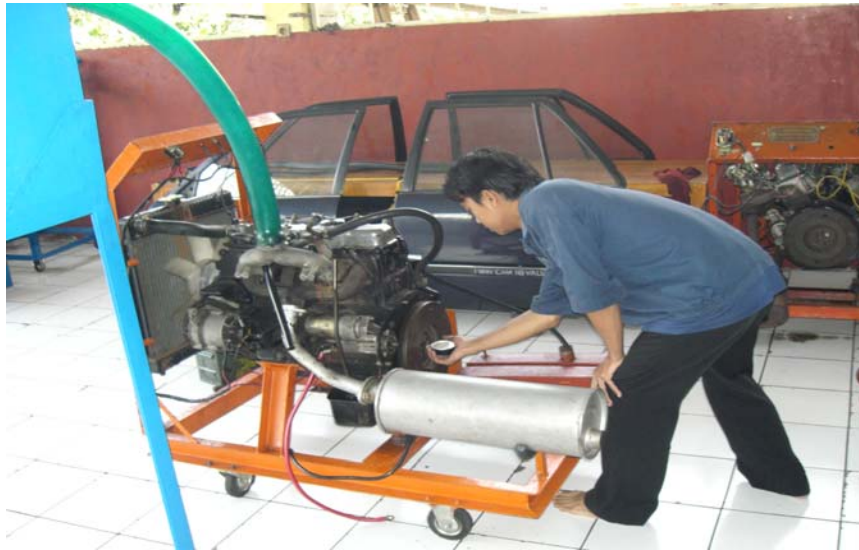
Gambar 5. Pengukuran putaran mesin dengan tachometer diesel
