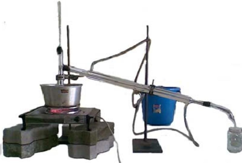
**Gambar 3.3. Rangkaian Alat Destilasi**
