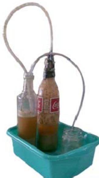
Gambar 3.2. Rangkaian Alat Proses Fermentasi
