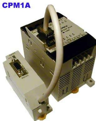
Gambar 2.2. Bentuk fisik Omron CPM1A
