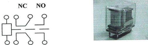
Gambar 2.13. Simbol dan bentuk fisik relay
