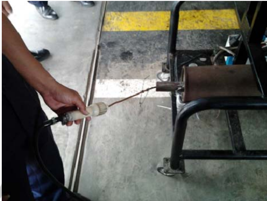
Gambar 5. Memasukkan probe tes ke dalam knalpot.
