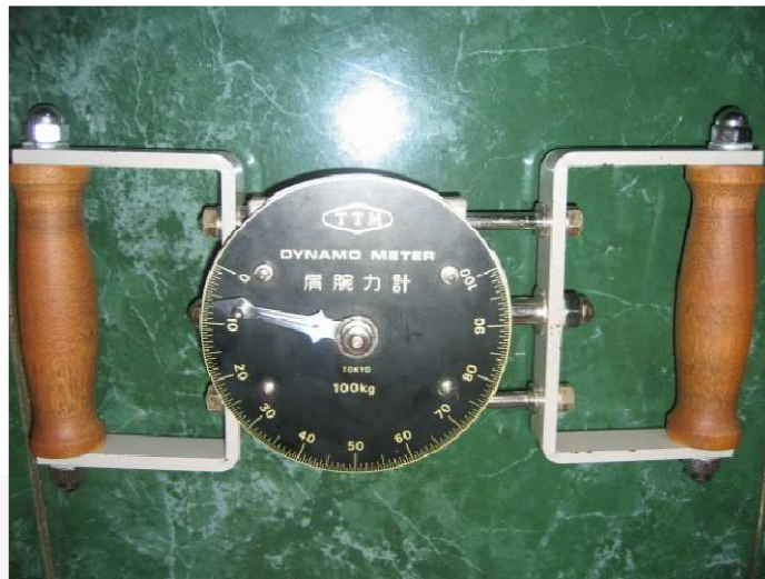
Gambar 11 Alat untuk mengukur kekuatan otot lengan ( pull and push dynamometer atau expanding dynamometer ) (Dokumentasi penelitian)
